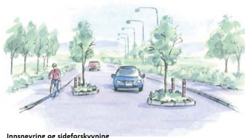
Innsnevring og sideforskyvning
