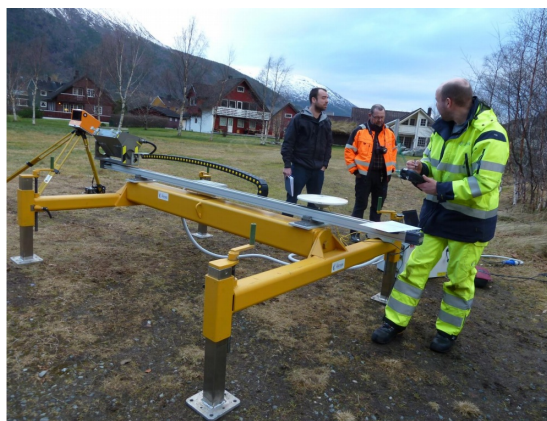
Figur 3: Utstyr for skredvarsling med radar
