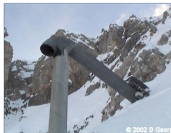
Figur 4: Skredutløsning med GazEx
