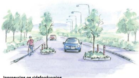
Innsnevring og sideforskyvning
