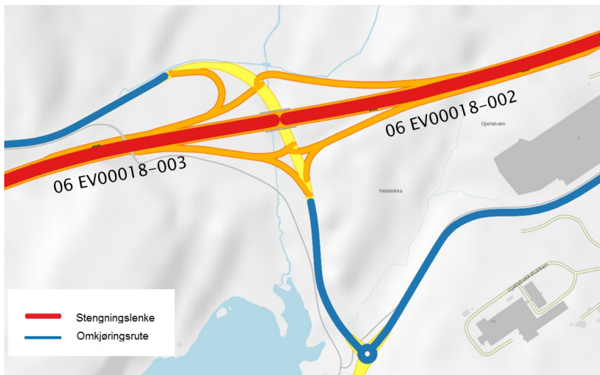
Figur 7: Eksempel på hvordan endepunktet for omkjøringsruter (blå) legges inn mot, men ikke inn i forgreininger i rampesystemer.
