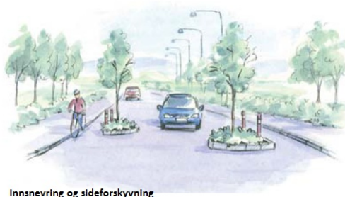
Innsnevring og sideforskyvning
