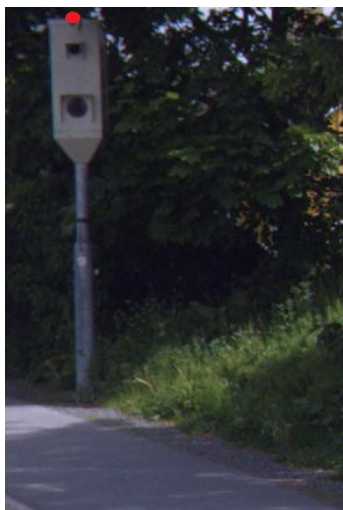
ATK-punkt måles inn i senter topp fotoboks som vist her med rød prikk
