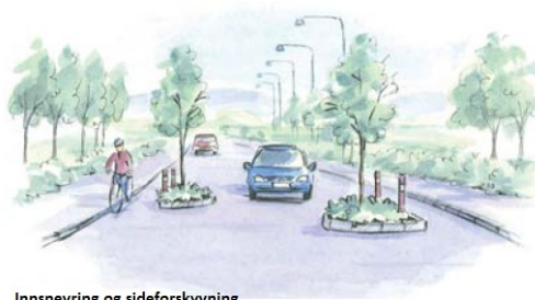
Innsnevring og sideforskyvning
