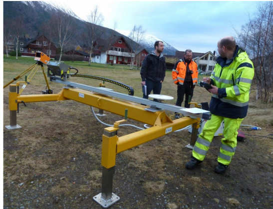
Figur 3: Utstyr for skredvarsling med radar
