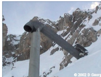
Figur 4: Skredutløsning med GazEx
