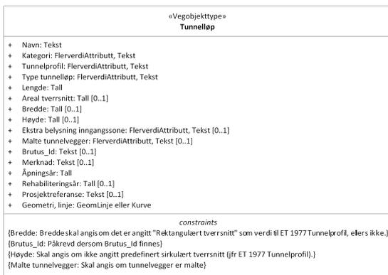
Figur 1: UML-skjema Tunnelløp
