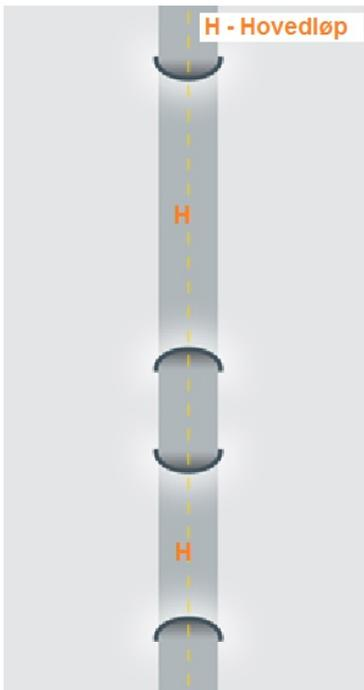
Når avstand mellom tunneløpene er svært kort (< 50 m) kan de defineres som en tunnel med to løp som ligger etter hverandre. Tunnallengde er da lengde av hvert enkelt løp + avstanden mellom løpene.
