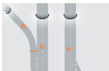
Tilfeller med to gjennomgående hovedløp (som figur) defineres med to løp som begge er "hovedløp", og et løp for hver rampe, disse av kategori "rampe".
