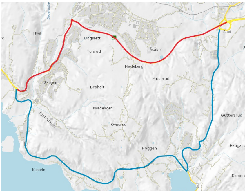
Figur 8: Merk at omkjøringsruten ikke er ført helt fram til endepunktet for stengningslenken i østre ende (ved Auvi), men starter nedstrøms av alle forgreininger og rampesystem inn mot hovedvegen.
