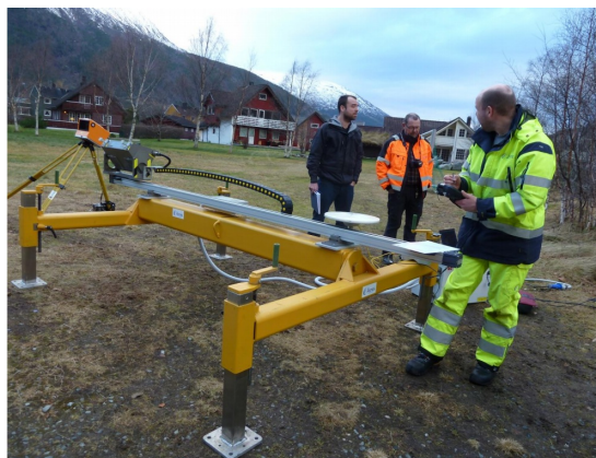
Figur 3: Utstyr for skredvarsling med radar
