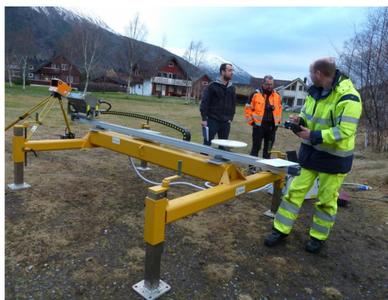
Figur 3: Utstyr for skredvarsling med radar
