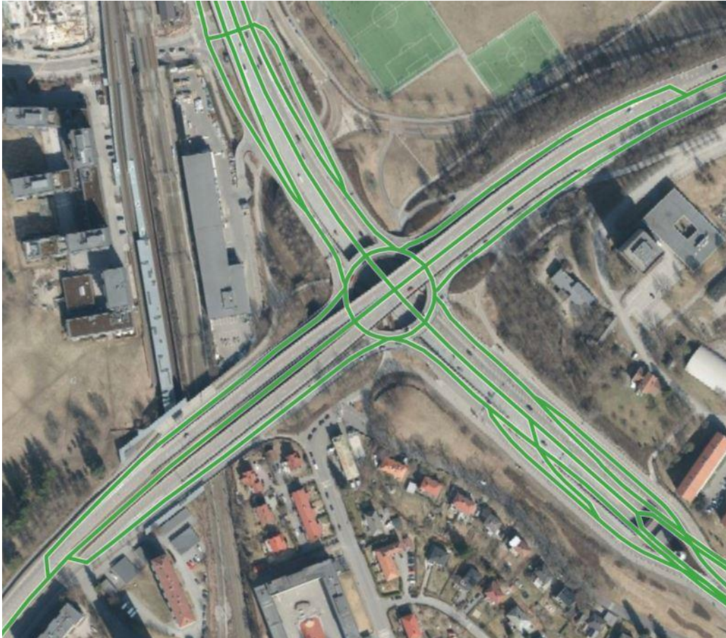
Figur 1 Feltstrekningsobjekt på vegtrasenivå og kryssdeler (Foto: Vegkart)
