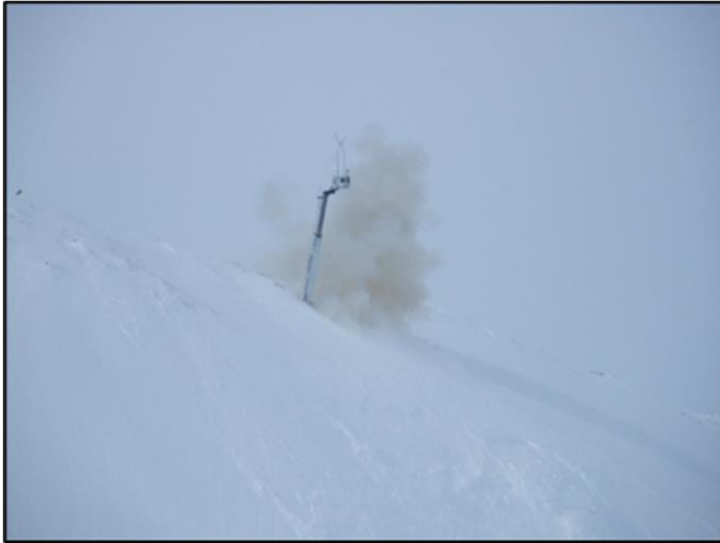
Figur 1 Skredutløsningstiltak (Foto: Njål Farestveit)
