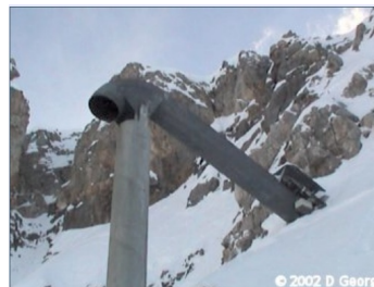
Figur 4: Skredutløsning med GazEx
