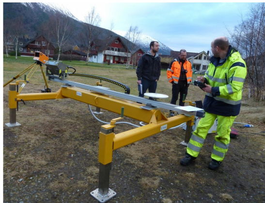
Figur 3: Utstyr for skredvarsling med radar
