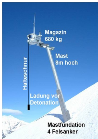
Figur 3: Skredutløsning med Wyssestår. Foto: Wyssen avalanche control AG
