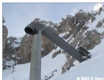
Figur 4: Skredutløsning med GazEx
