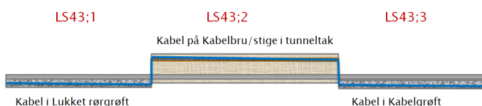
Figur 4: Splitting av kabel når framføringsveg endres.
