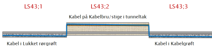
Figur 4: Splitting av kabel når framføringsveg endres.
