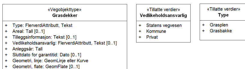
Figur 2: UML-skjema tillatte verdier
