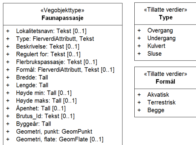
Figur 2: UML-skjema tillatte verdier
