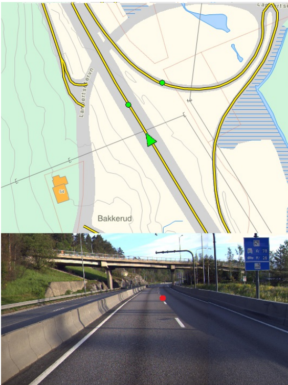
Eksempel på veg med to automatiske bomstasjoner. Rødt punkt viser anbefalt punkt for registrering geometri på hovedvegens (E6) bomstasjon.
