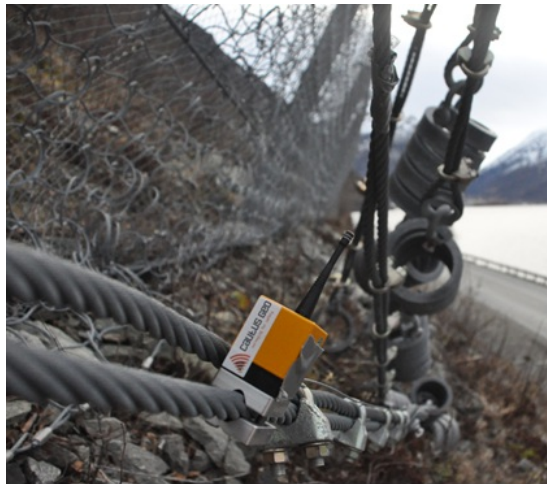
Figur 4: Rystelsesmåling på fanggjerde. Foto: Halgeir Dahle
