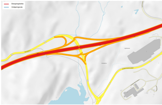
Figur 7: Avslutning av stengningslenke i 2-planskryss.
