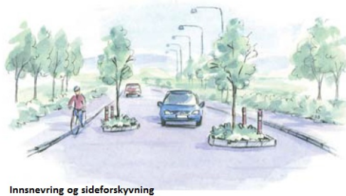
Innsnevring og sideforskyvning
