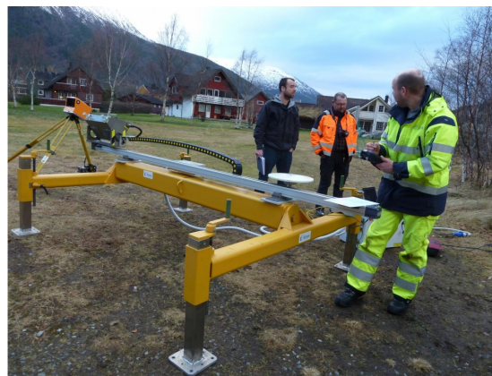
Figur 3: Utstyr for skredvarsling med radar
