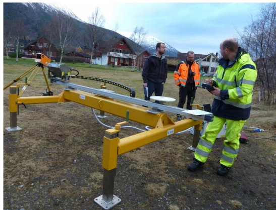
Figur 3: Utstyr for skredvarsling med radar
