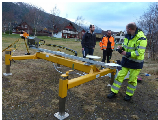
Figur 3: Utstyr for skredvarsling med radar
