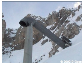
Figur 4: Skredutløsning med GazEx
