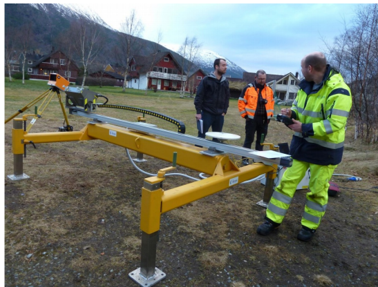
Figur 3: Utstyr for skredvarsling med radar
