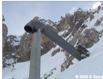
Figur 4: Skredutløsning med GazEx
