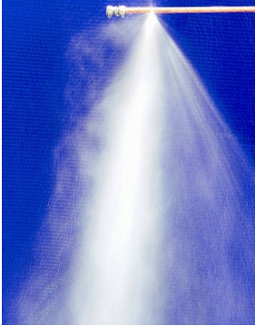
Brannslukking med vanntåke
