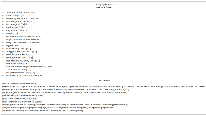
Figur 1: UML-skjema for Trekkerør/kanal
