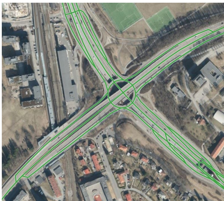
Figur 1 Feltstrekningsobjekt på vegtrasenivå og kryssdeler (Foto: Vegkart)
