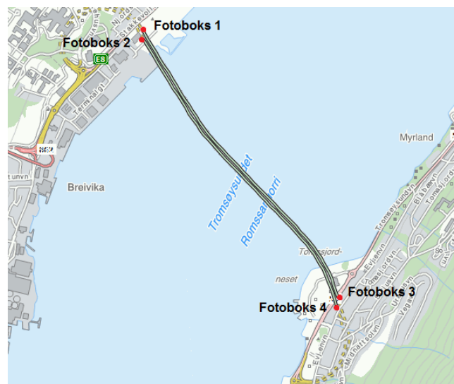
Streknings-ATK i Tromsøsundet. Strekning registreres fra første til andre fotoboks i en retning.
