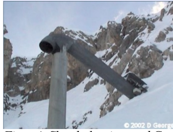
Figur 4: Skredutløsning med GazEx
